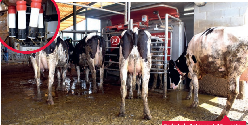
Cada Lely Astronaut A5 cuenta con báscula y con contador de células somáticas
