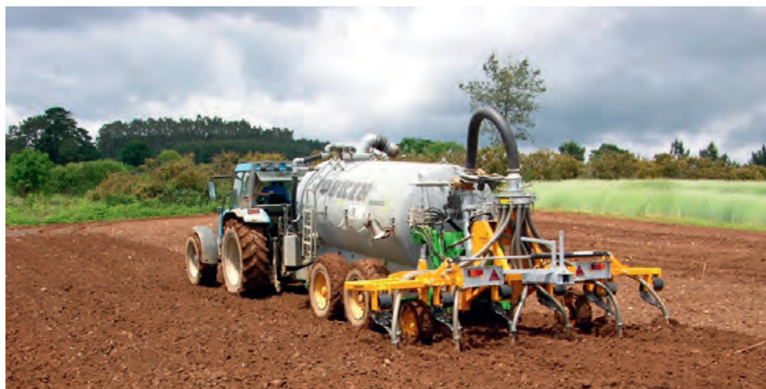
En la aplicación de los purines el uso de técnicas de baja emisión es el más efectivo para reducir la volatilización del amoníaco
